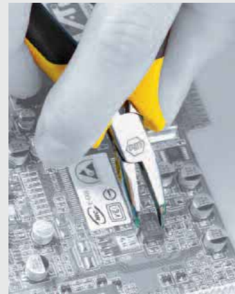
Szczypce półokrągłe Professional ESD są stosowane przeważnie do chwytania i zaginania.
